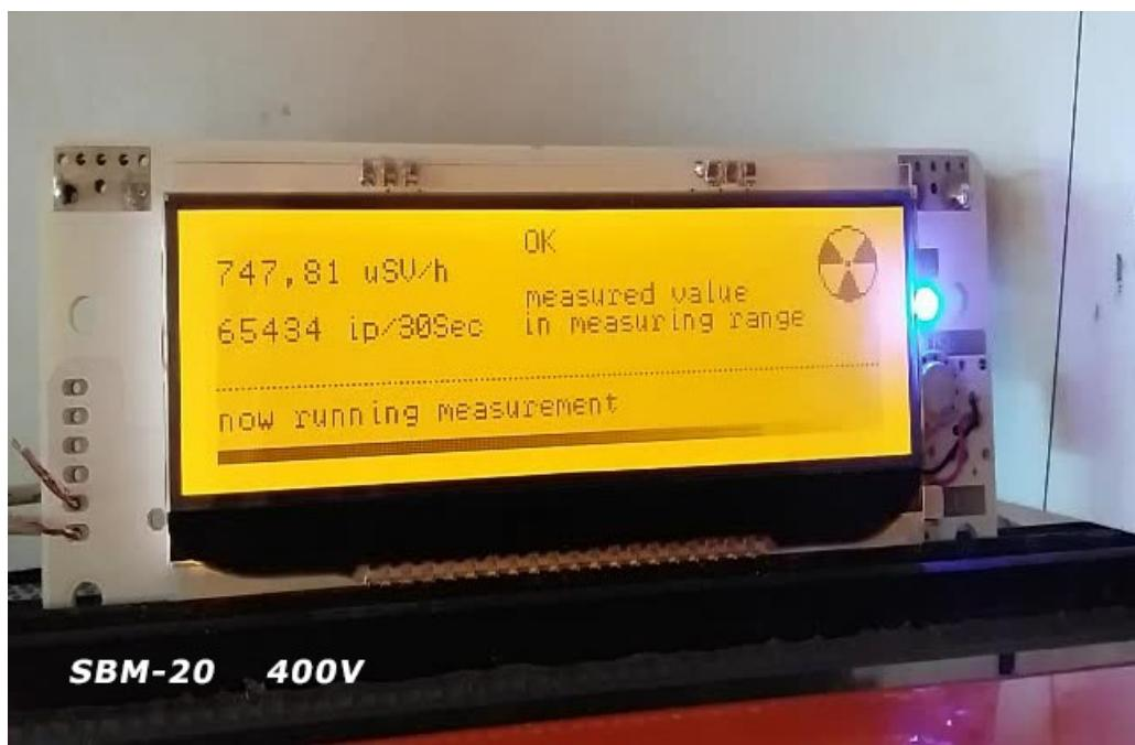
my R51 wurde auf einem amtlichen Prüfstand mit einem Cs-137 Prüfstrahler getestet. Entfernung zur Quelle ca. > 2,5m Ergebnis: alle von my R42 angezeigten Werte stimmen überein mit dem Ist ODL Wert. Bei einer Leistung von 1,00 mSv/h werden 1,01 mSv/h von my R42 angezeigt. Das SBM-20 Rohr arbeitet bis ca. 1,4 mSv/h. Ein 50-faches Überlasttest wurde bestanden.
